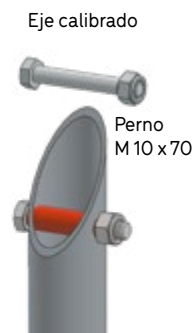
Anillo de acero inoxidable antidesgaste en la articulación
